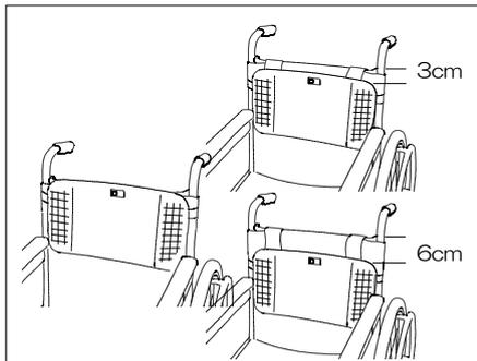
①ベース部を取り付ける高さを決めます。背シート上端と3cm下方、6cm下方の三段階に高さを調整できます。
